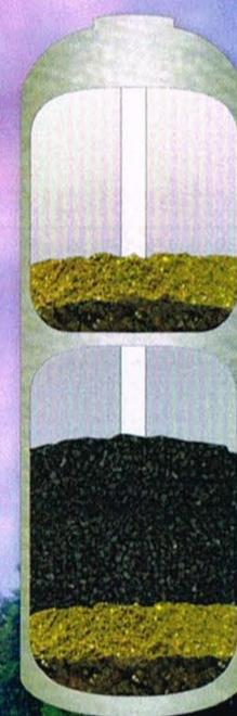
Cette configuration est destinée pour le traitement du chlore présent dans les eaux municipales. Cet appareil permet d'enlever le goût et l'odeur résultant de la désinfection au chlore. Le média présent dans le compartiment du haut assure une très longue durée de vie au charbon. Cette configuration ne traite pas la dureté, le fer et le manganèse.
