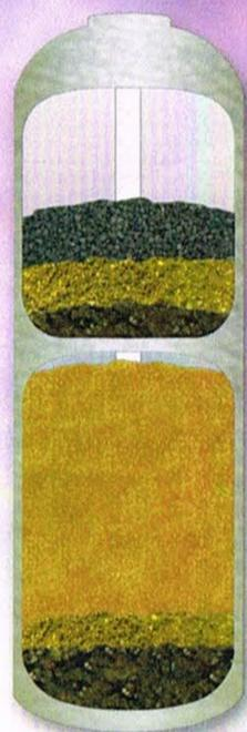
Cette configuration permet d'ajouter un média dans le compartiment du haut afin de régler des problèmes que l'adoucisseur ne peut résoudre. Par exemple, en plus d'adoucir et d'enlever le fer ferreux et manganèse, nous pouvons traiter le soufre, le fer ferrique et améliorer le traitement du fer ferreux et du manganèse lors de concentration plus élevée.
